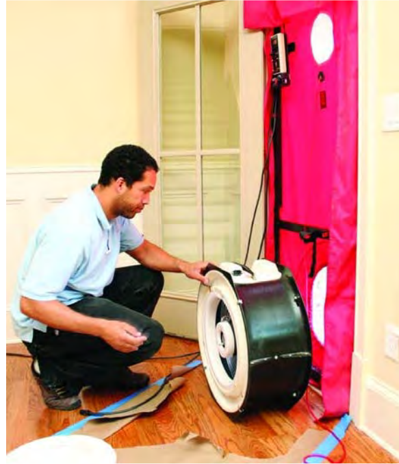
Blower Door Setup in Door Frame
