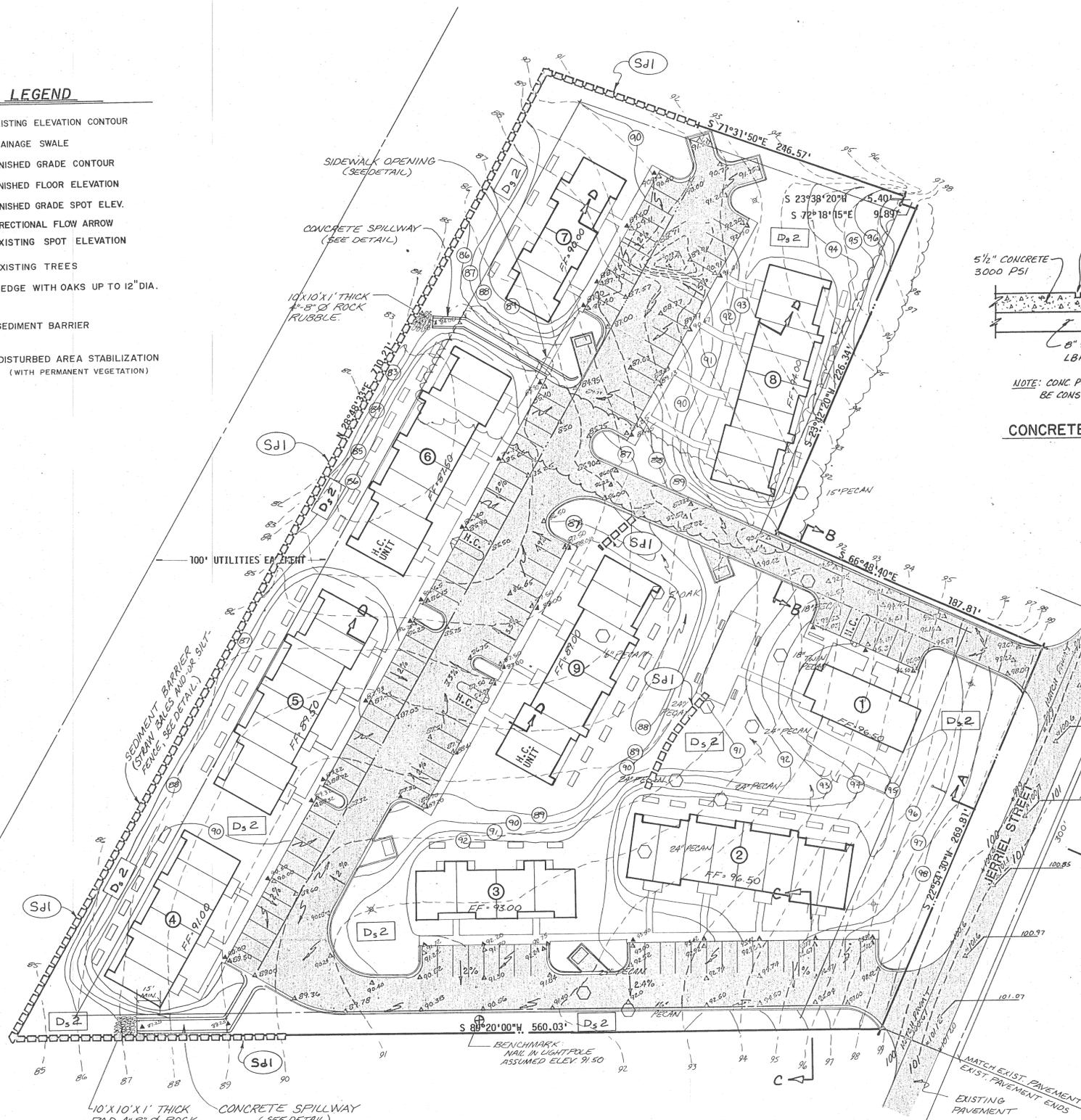
**SITE PLAN FOR PAVING, GRADING & DRAINAGE**
